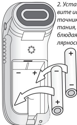
Рис. 5. Порядок замены источников питания аппарата ДиаДЭНС-Т
