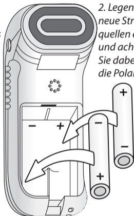
Abb. 5. Die Ordnung des Ersatzes der Stromquellen des Apparates DiaDENS-T.
